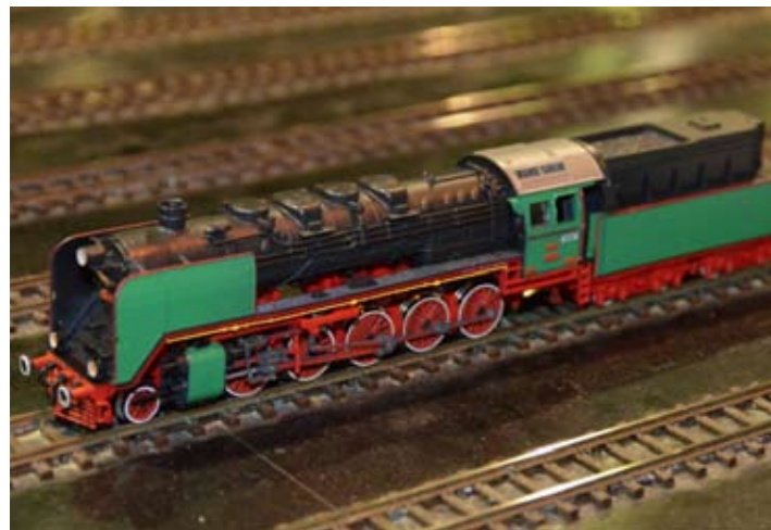
MADE IN GERMANY: Eine BR 14 der Bulgarischen Staatsbahnen. Es handelt sich um die ehemalige DR-Baureihe 50 mit Ölzusatzfeuerung.
